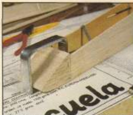
12. Encolar y fijar mediante un gato, el taco de balsa previsto para el morro del modelo. Más tarde se dará forma utilizando una lima.
