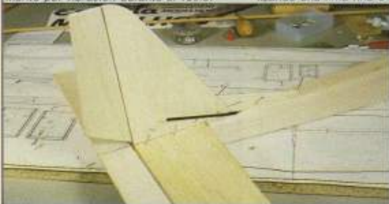
32. Trazar una línea en el centro del estabilizador y pegar el timón de dirección, respetando 90^\circ respecto a los dos lados del timón de profundidad. Utilizar una escuadra para ello.
