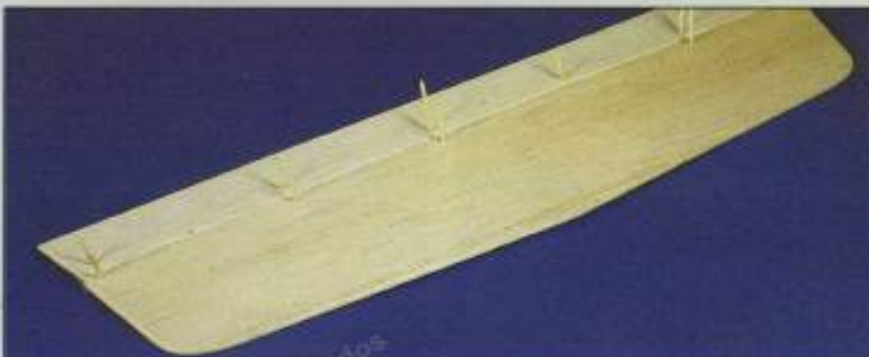
28. En las zonas indicadas, taladrar e introducir palillos con adhesivo. Realizar los taladros con precaución, con el fin de no astillar la madera.
