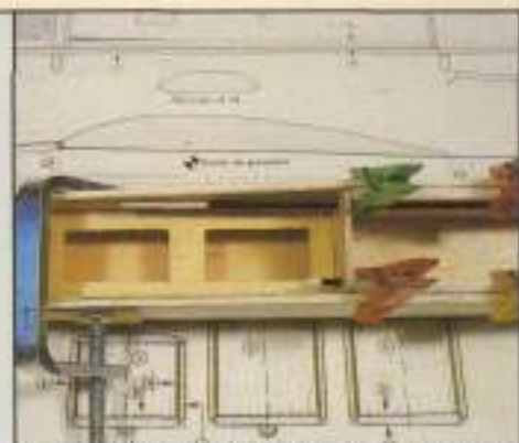
14. En el interior, pegamos el soporte para los servos, sujetándolo mediante un gato. Situar en el punto indicado en el plano.
