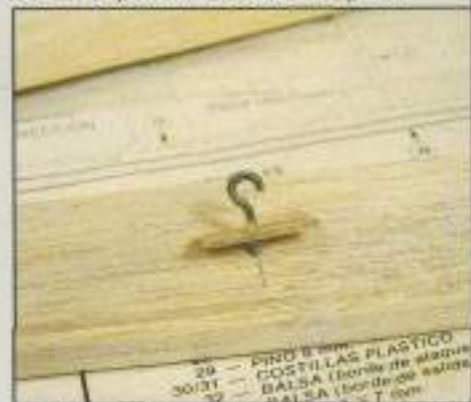
17. La tapa del compartimento de radio se forma con dos piezas de balsa y un refuerzo para el sistema de cierre.
