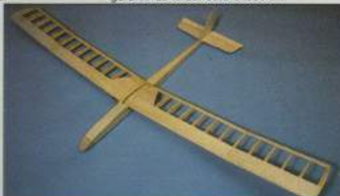
33. Un suave lijado general y ya podemos colocar las alas en su sitio, fijándolas mediante gomas, para así admirar el aspecto de nuestro excelente modelo.
