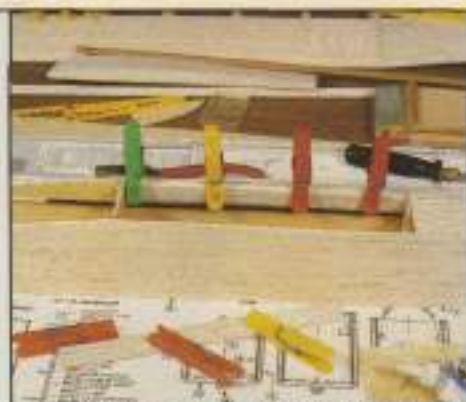
13. En la zona de apoyo del ala se colocan unos refuerzos triangulares de balsa, que se sujetarán con pinzas de la ropa.
