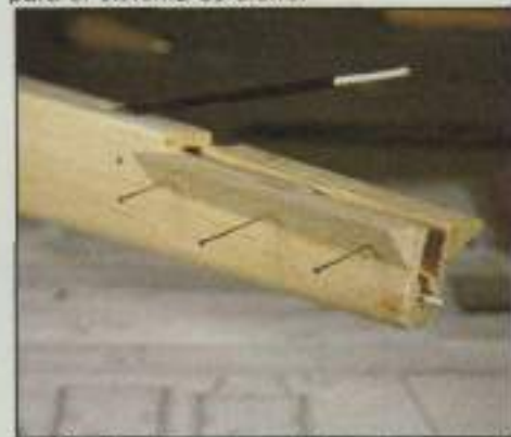
20. Se fijan los refuerzos triangulares para el apoyo del estabilizador. De la situación de éstos dependerá la correcta alineación.
