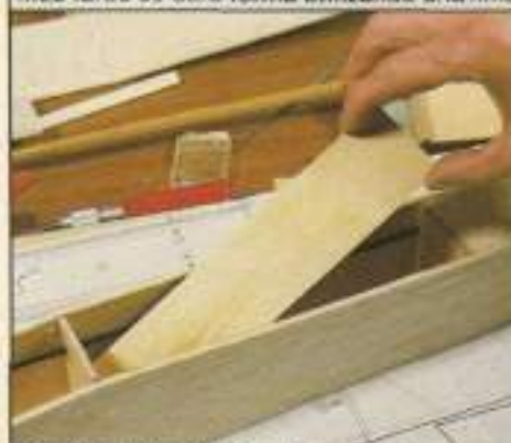
15. El «suelo» del fuselaje va reforzado con unas piezas de contrachapado que encolaremos fijándolas mediante un peso.
