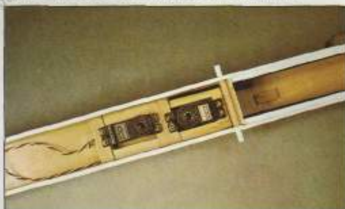
4. Es importante seguir las instrucciones de montaje de servos, y utilizar las arandelas y anillos de goma que recomiendan.
