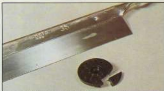
7. Si el brazo del servo es circular, deberá cortarse un sector para facilitar el desplazamiento del kwik link.
