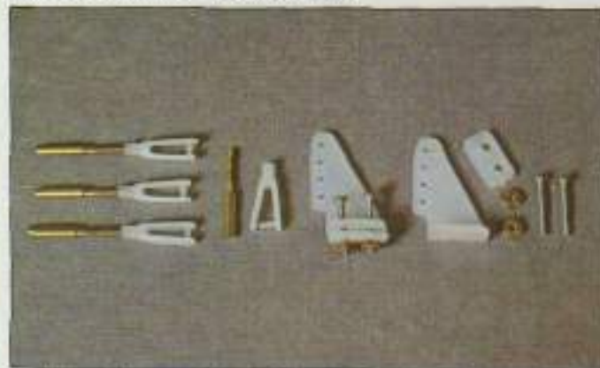
5. El siguiente paso es instalar las transmisiones del mando. Prepararemos los kwik links, escuadras y demás accesorios.
