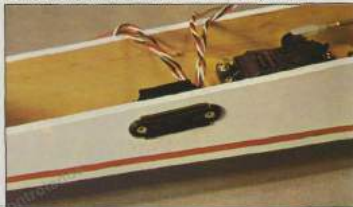
18. El interruptor se fija con los tornillos que trae para tal fin. El paso siguiente es realizar la conexión de los distintos elementos.
