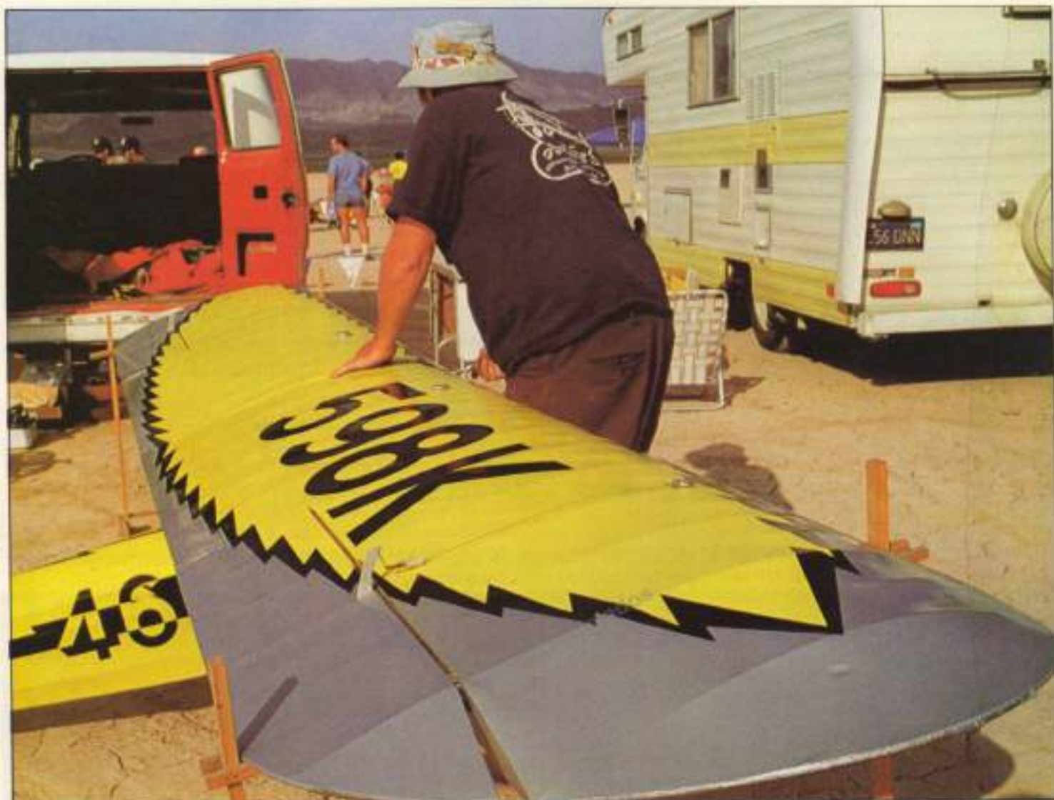
Gigantesco modelo con los cables de mando en el exterior del ala, guiados por unas poleas. Es una reproducción del modelo real.
