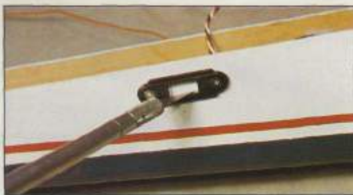
16. Cortar el hueco para el deslizamiento del interruptor desde el exterior, marcando el cuadro con la misma plantilla.
