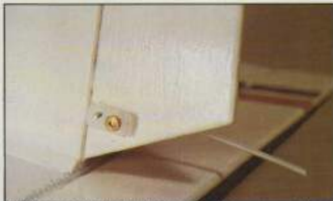
10. Una vez realizados los taladros se fija el horn con unos tornillos y tuercas, utilizando una pieza de refuerzo en el lado opuesto.
