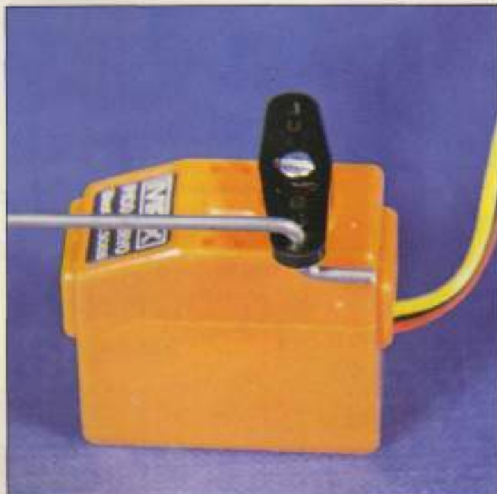
Detalle de la conexión en «Z» en el brazo de un servo.
