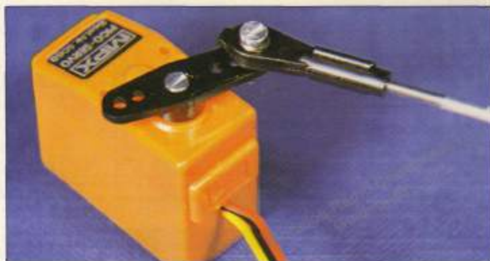
La fijación de esta rótula al brazo del servo, se realiza mediante un tornillo con tuerca.
