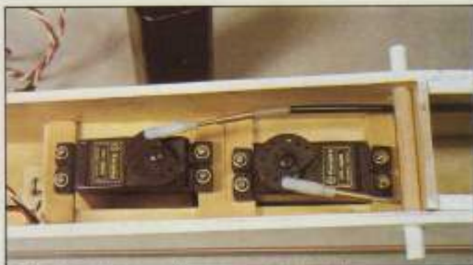
8. Se comprobará que los servos efectúan todo su recorrido sin encontrar obstáculos o rozamientos.
