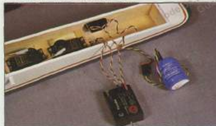
19. La batería, el receptor y el interruptor son conectados entre sí, siguiendo las instrucciones según cada equipo.
