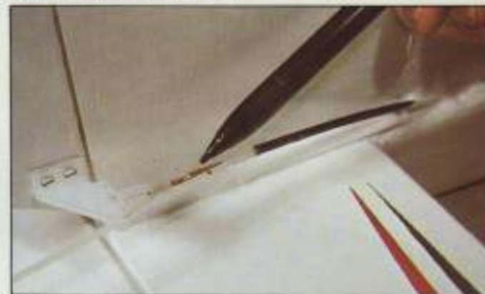
13. Se marca la longitud correcta, se introduce en el adaptador y se fija con pegamento rápido de cianocrilato.
