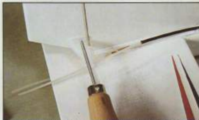
9. El paso siguiente es colocar las escuadras de mando (horn) para lo cual marcaremos unos puntos en el lugar correspondiente.
