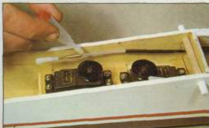
6. En un extremo de los cables de plástico se pegan los adaptadores metálicos para los kwik links.
