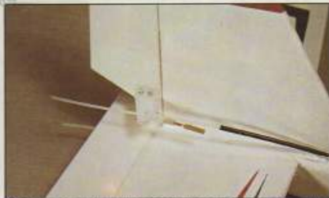
12. Se monta el otro extremo de la transmisión, para lo cual se corta la varilla, contando con la longitud del kwik link y su adaptador.
