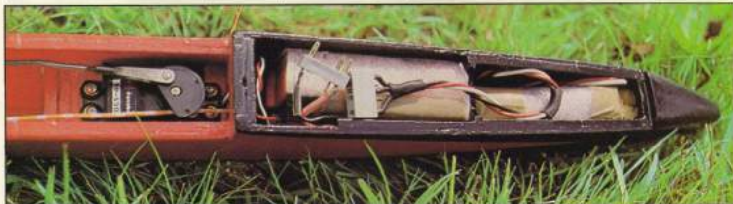
La fotografía muestra un velero con el equipo de radio instalado en un espacio excesivamente reducido. Se aprecia un solo servo para el control de profundidad, ya que, el correspondiente a los alerones va fijado al ala.
