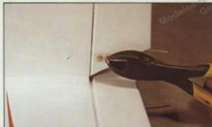
11. El sobrante de los tornillos es conveniente cortarlo, repasando con una lima los extremos.
