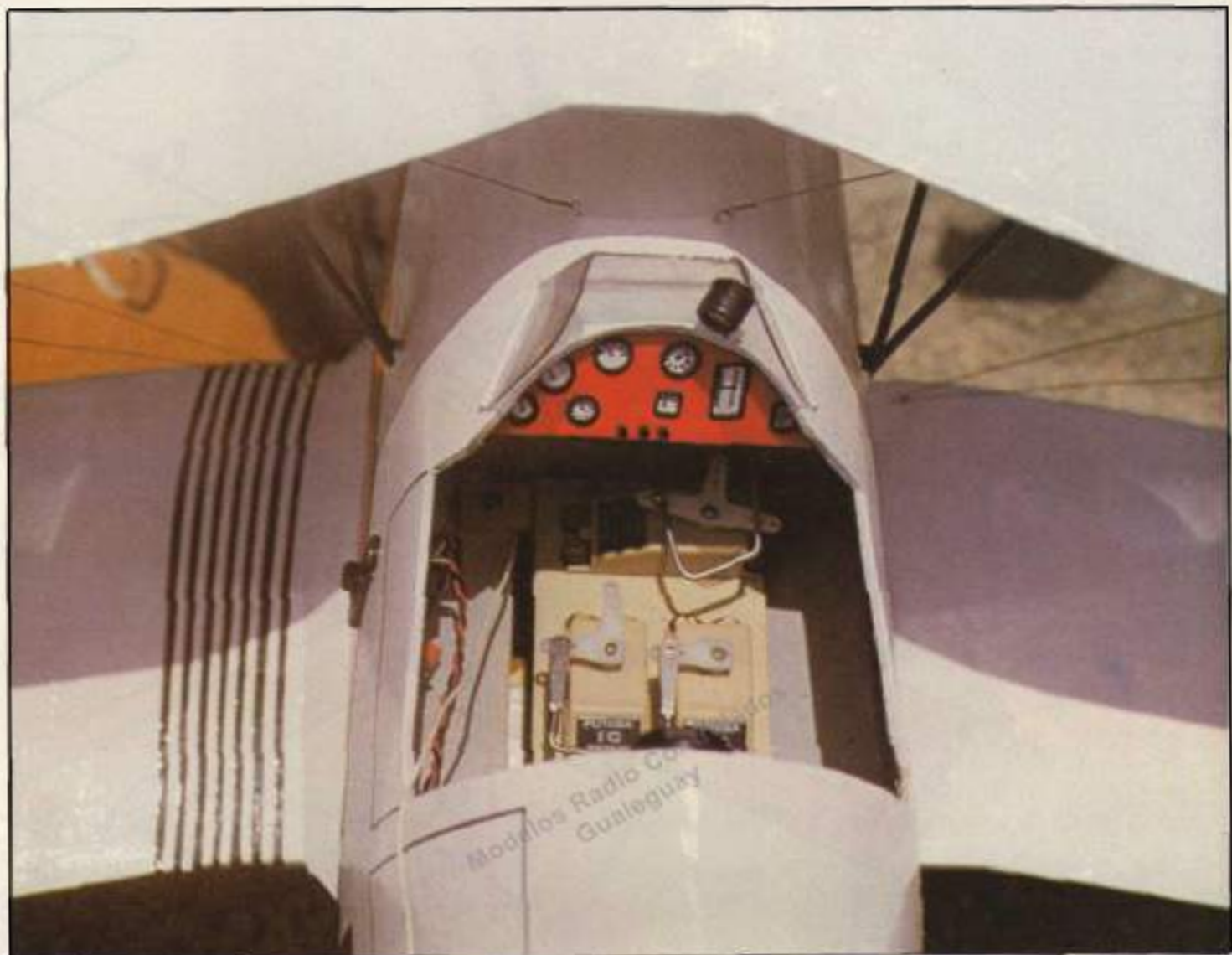
Conjunto de servos instalados en la cabina de un biplano, ocupando el supuesto lugar del asiento del piloto.
