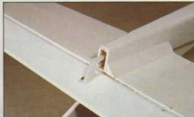
14. La misma operación se realiza con el timón de profundidad. Asegurarse de la buena fijación de estas piezas.
