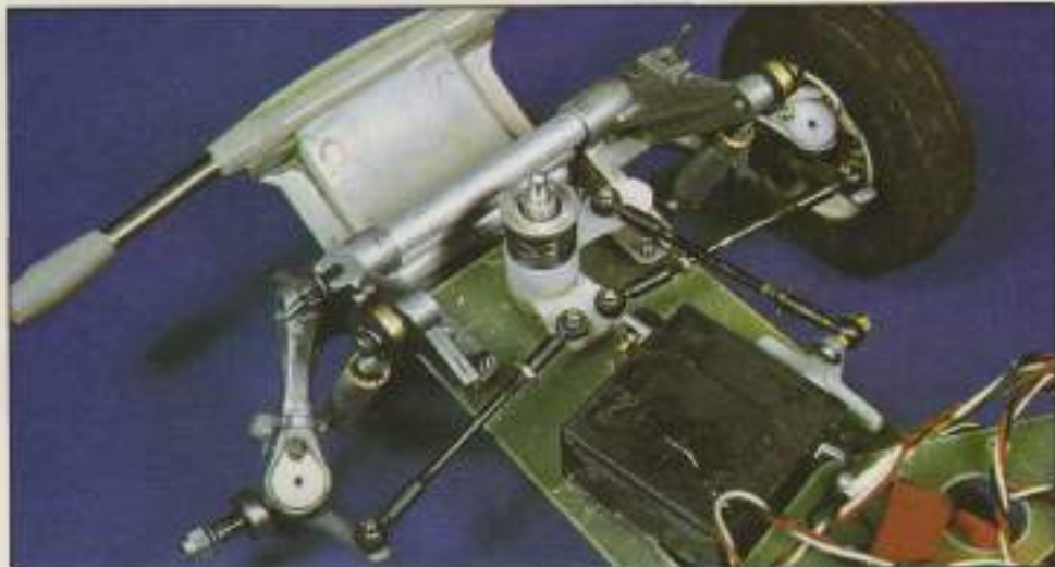
Sistema completo de dirección con salva-servo, un mecanismo que reduce las posibilidades de daño en el sistema, tanto en el servo como en la transmisión.
