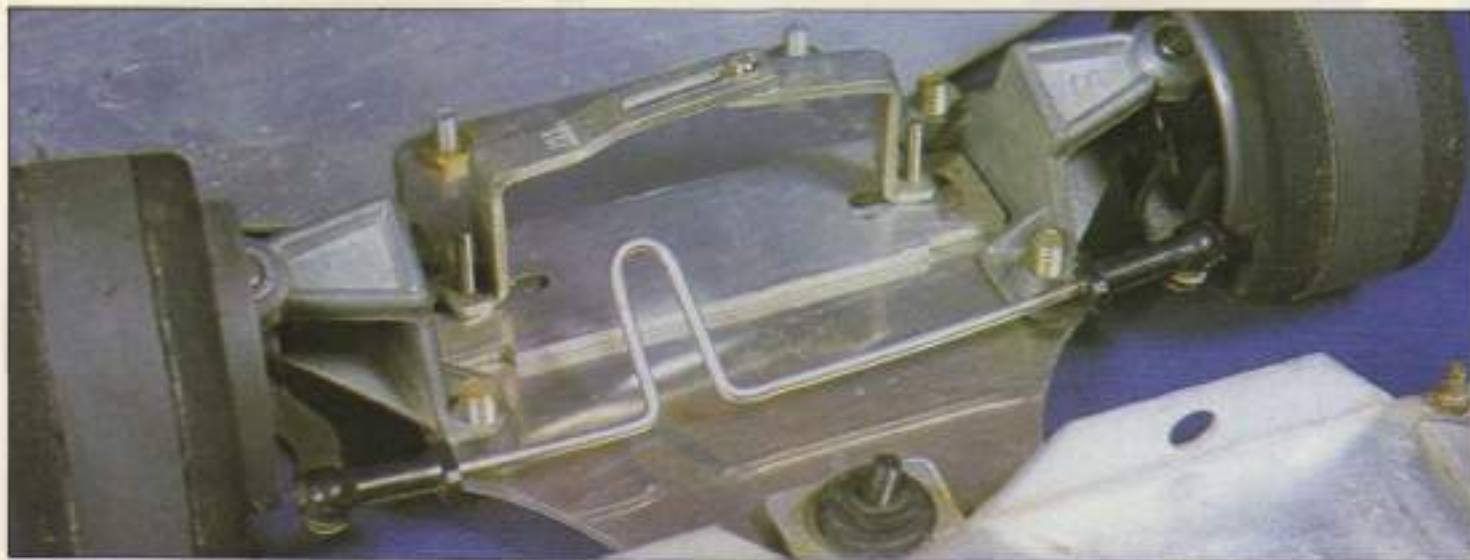
Sistema de dirección simple, sin salva-servo. La conexión se realiza en el pliegue que se aprecia en la barra de transmisión.
