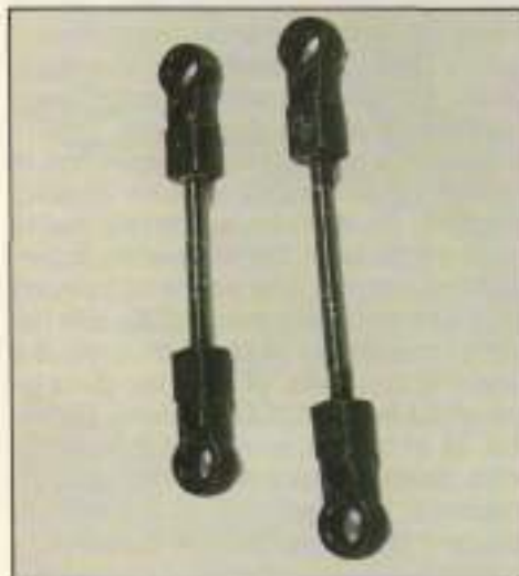
Rótulas con rosca para facilitar los reglajes de convergencia.
