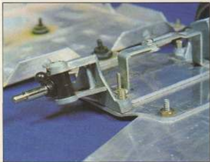
Una mangueta clásica sobre dos apoyos del puente.
