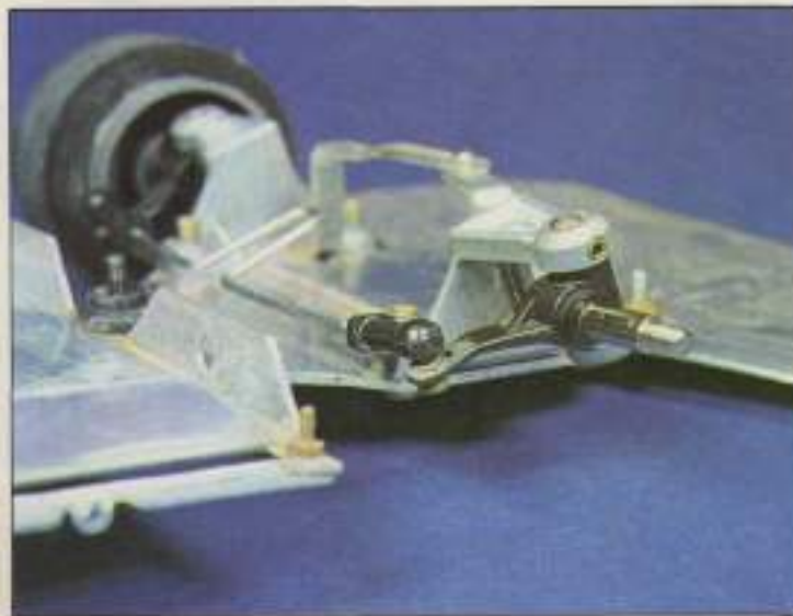
Se aprecia claramente la inclinación o cáster de la mangueta.
