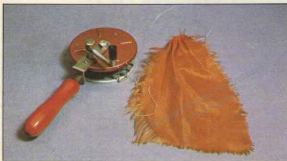
Polea para la recogida rápida del cable de remolque con banderola y anilla.
