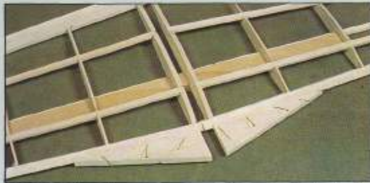
14. Presente dos refuerzos triangulares «N» de unión del ala al fuselaje, y ajuste el asiento con el borde de ataque.
