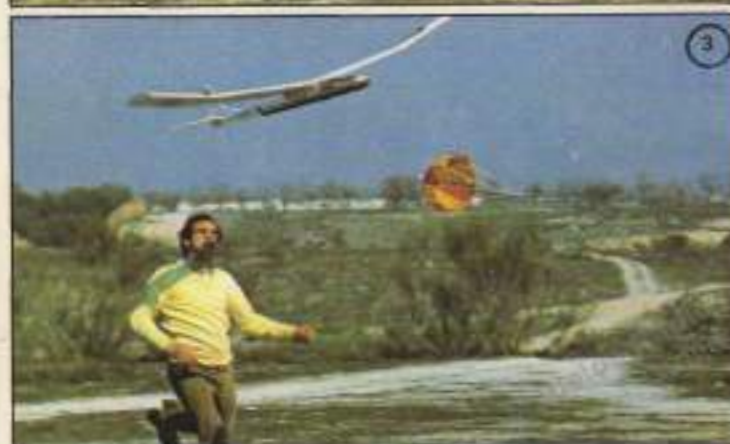
1. El ayudante inicia la carrera cuando el cable empieza a tirar; 2. El velero adquiere sustentación con la velocidad; 3. Se suelta el velero, el cual inicia la trepada; 4. Una vez suelta la anilla, el velero empieza el vuelo planeado y el paracaídas señala la caída del cable.
