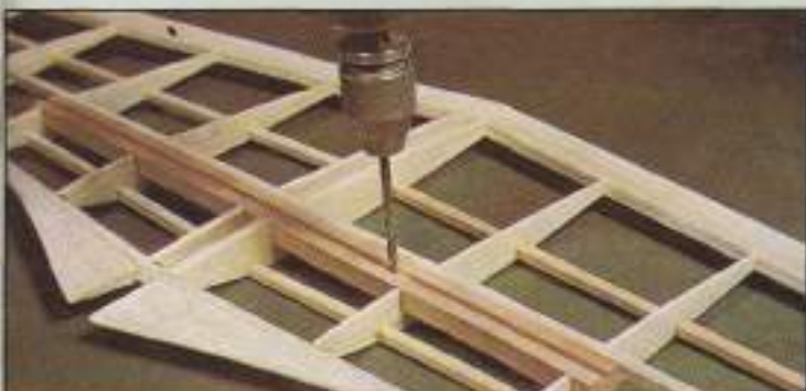
15. Haga los taladros para fijar las patas del tren delantero.
