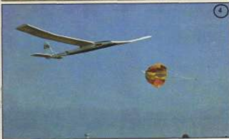
1. El ayudante inicia la carrera cuando el cable empieza a tirar; 2. El velero adquiere sustentación con la velocidad; 3. Se suelta el velero, el cual inicia la trepada; 4. Una vez suelta la anilla, el velero empieza el vuelo planeado y el paracaídas señala la caída del cable.
