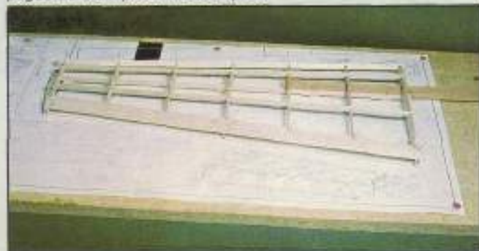
8. Cierre la estructura del ala con los largueros superiores J, procurando que ajusten en sus alojamientos.
