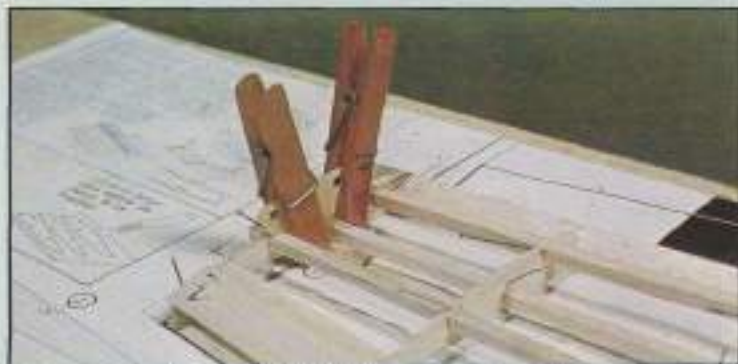
13. Pegue la guía de salida de hilos y asegure la unión con pinzas corrientes de la ropa.
