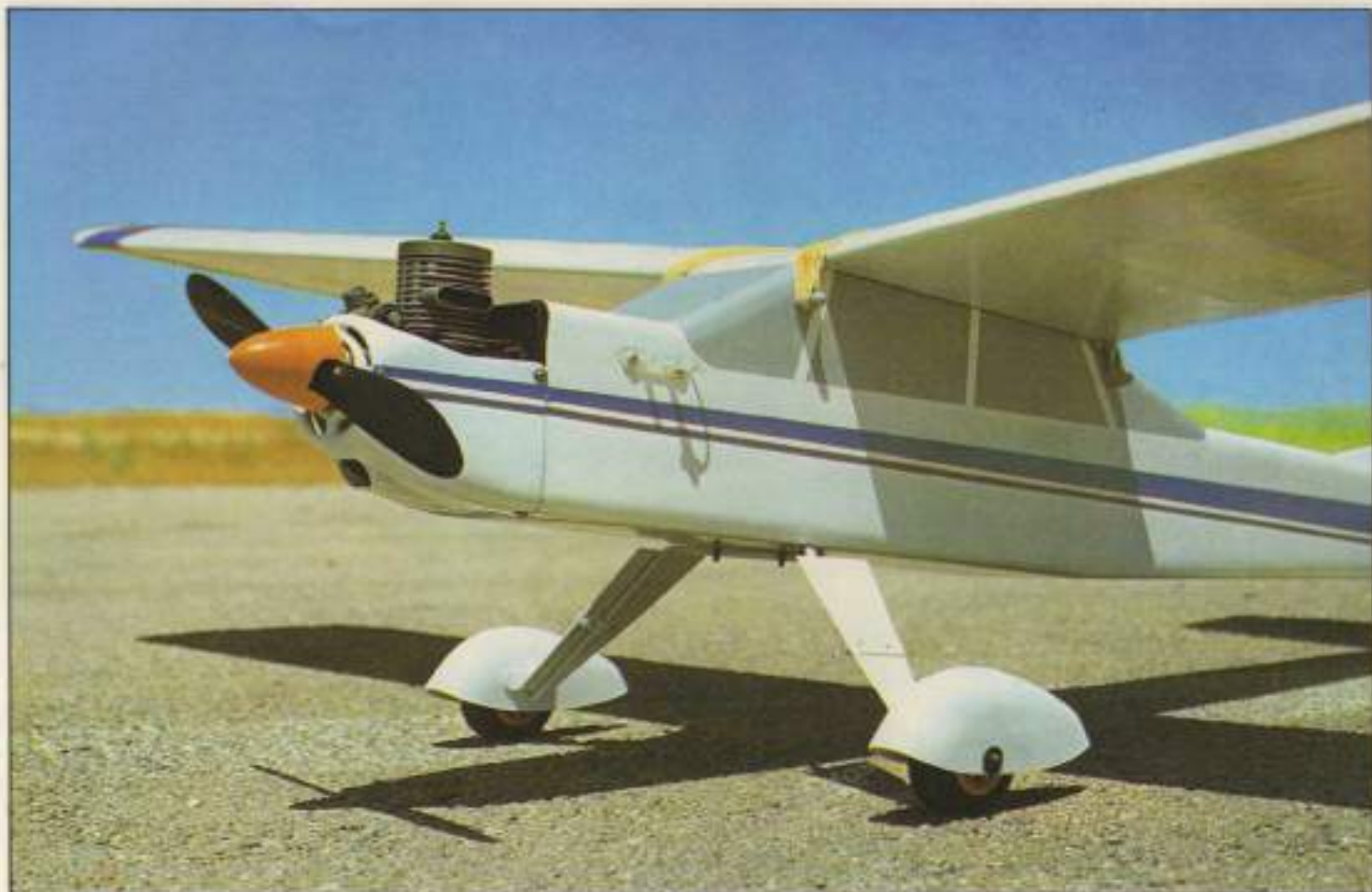
El tren de aterrizaje convencional es la solución menos empleada por su dificultad para el despegue y la desprotección de la hélice.
