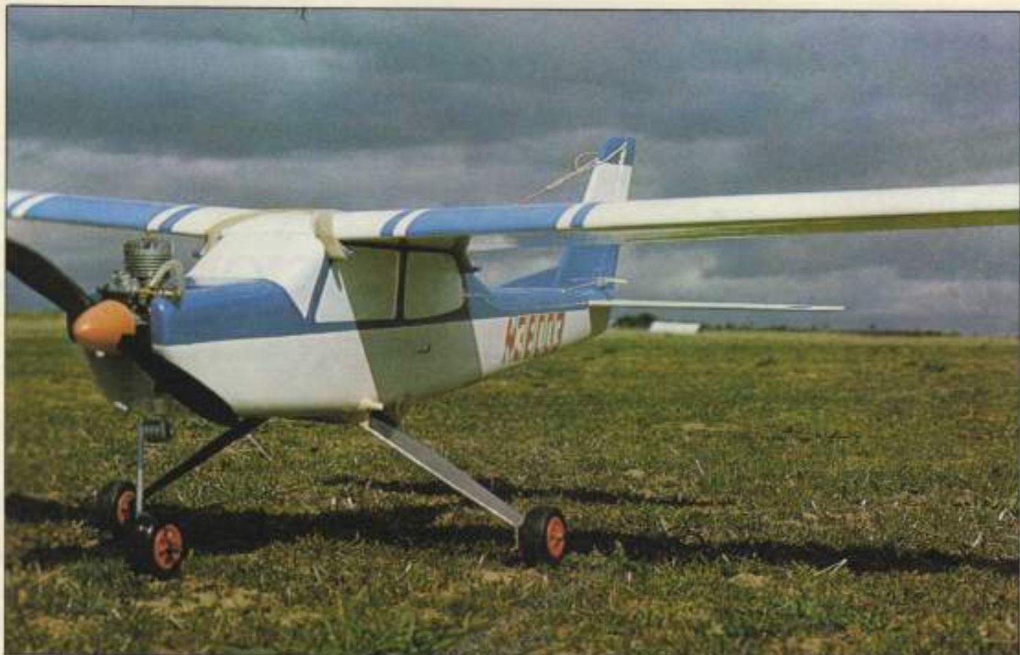
El avión de la foto es el prototipo clásico de modelo para iniciación al vuelo con motor, identificable por el tren triciclo, ala alta y motor vertical.
