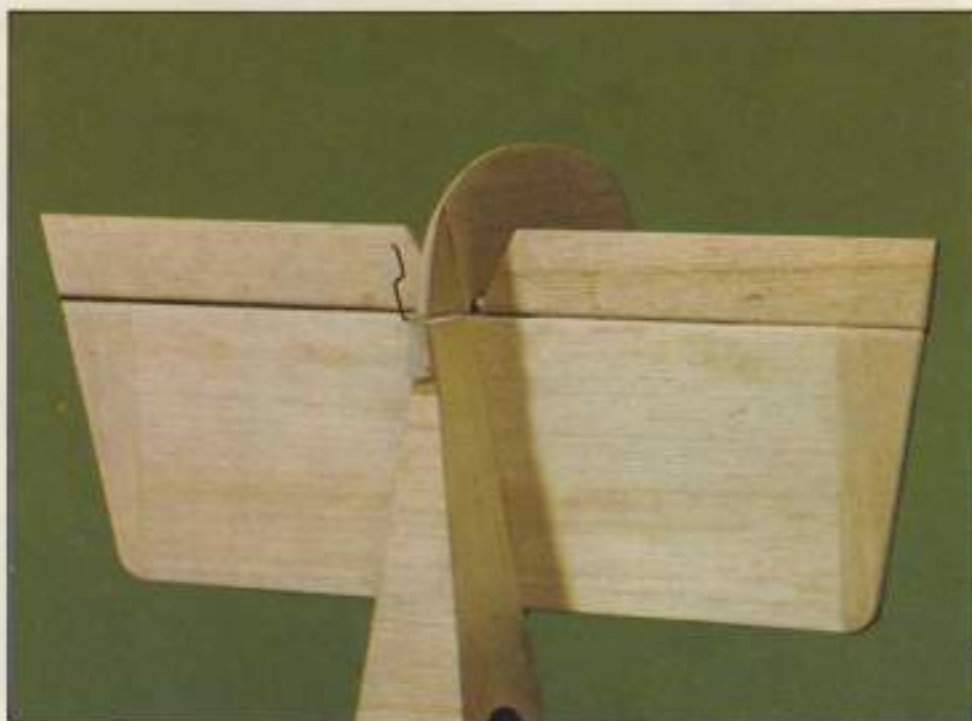
Empenaje o conjunto de estabilizadores simple, construido a partir de tablas de balsa estándar, sin perfil aerodinámico. Fácil construcción y suficiente rendimiento.
