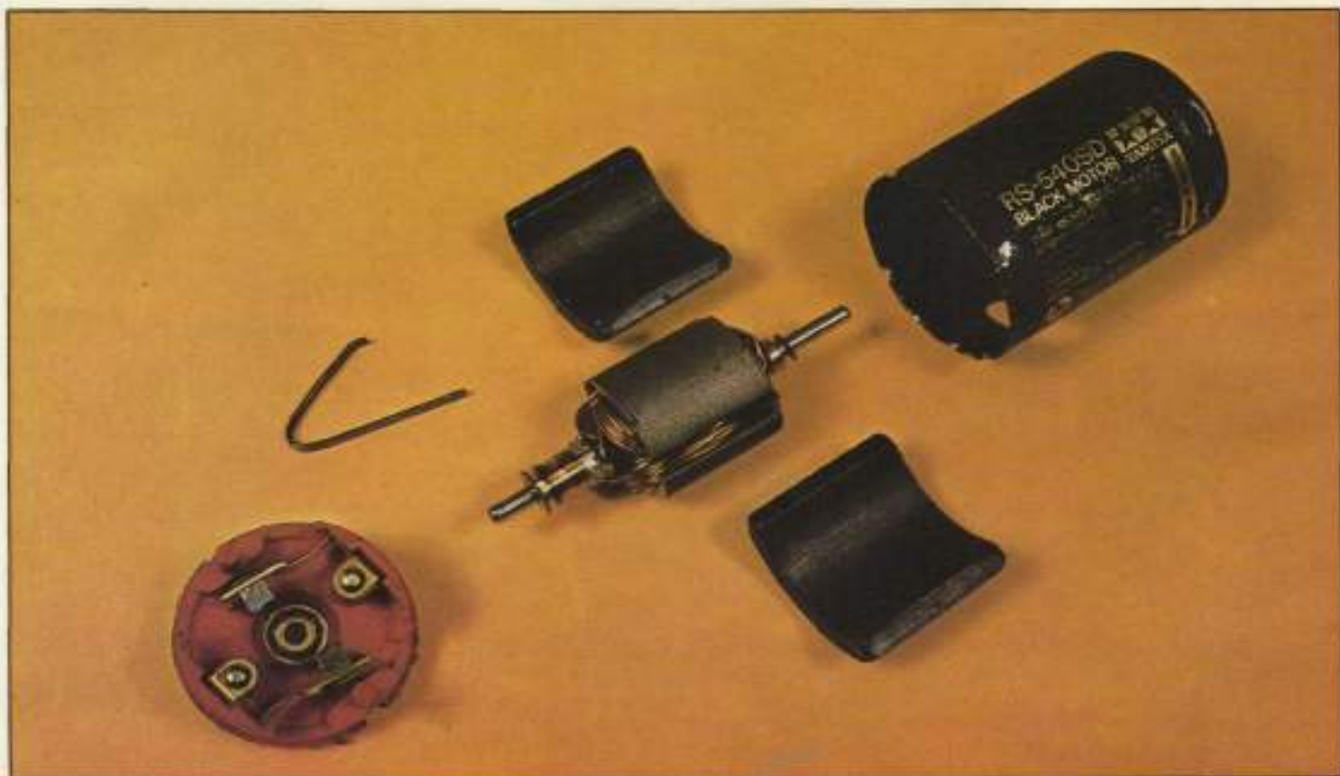
Despiece de un motor eléctrico «Mabuchi», empleado habitualmente en los automodelos RC, en distintas versiones.
