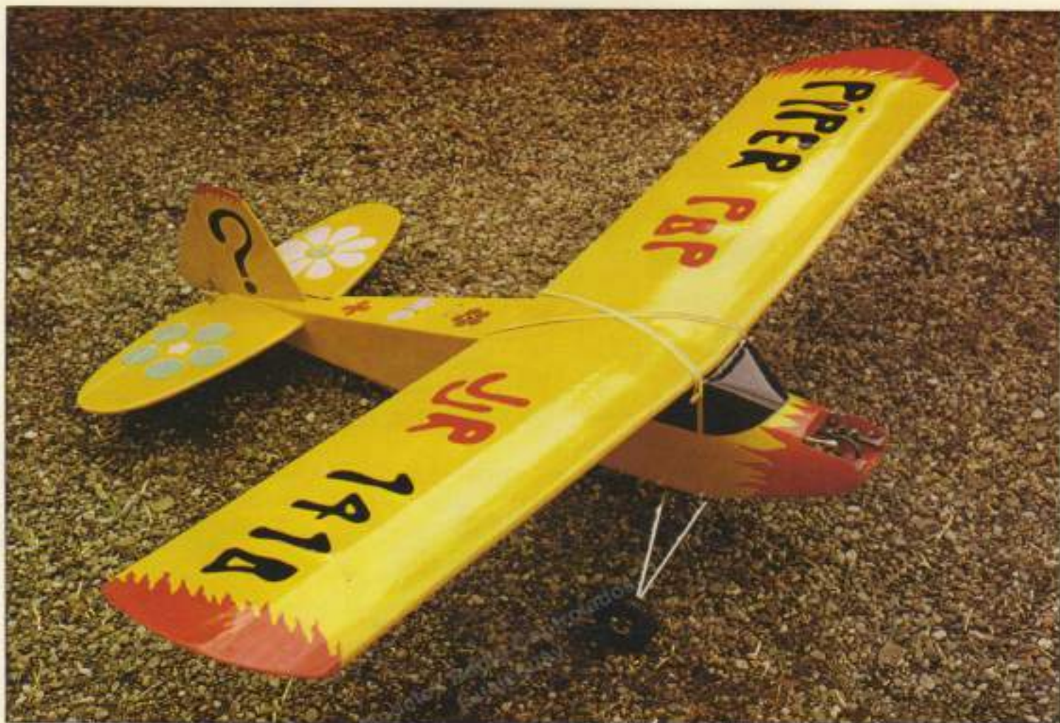
Los modelos demasiado pequeños no son convenientes para aprender debido a su excesiva carga alar, lo cual dificulta las condiciones de vuelo.
