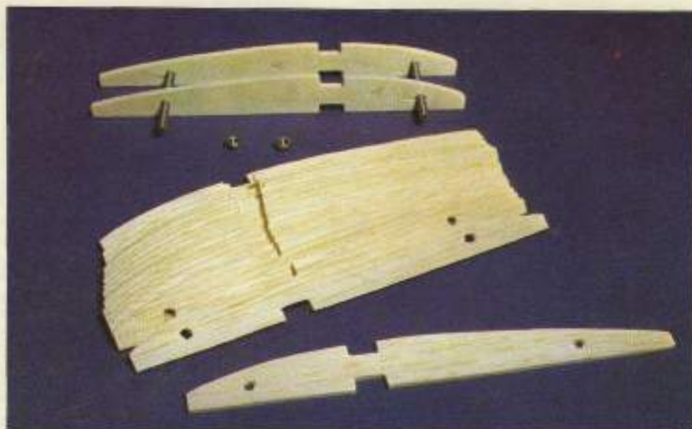
Conjunto de costillas cortadas en bloque, unidas por dos tornillos pasantes.
