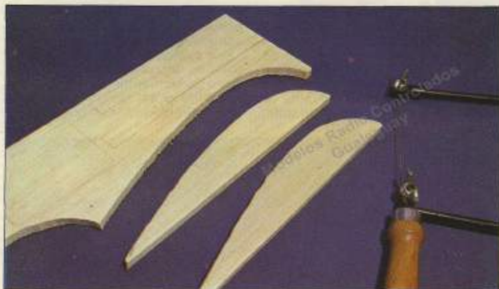
Los bordes marginales se pueden hacer uniendo dos o más piezas para conseguir el espesor.
