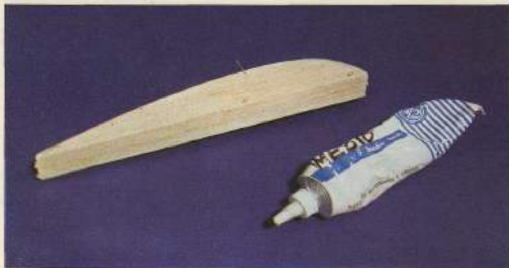
Las piezas que forman el borde marginal se unen mediante pegamento, sujetándolas con alfileres hasta su secado. Mas tarde serán lijadas para obtener su forma definitiva.
