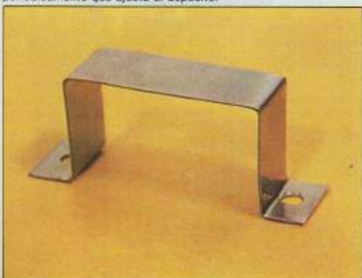
12. Comprobar de nuevo la correcta medida de los lados de la brida, y que apoya perfectamente en una superficie plana.
