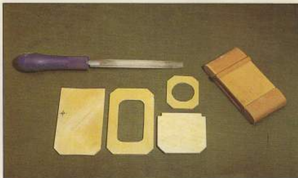
Antes de iniciar el paso siguiente cortaremos las cuatro cuadernas que lleva el fuselaje.
