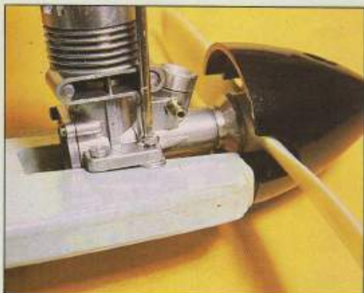
7. Se fija el motor con tornillos y tuercas, suplementando con dos arandelas en los dos taladros delanteros.
