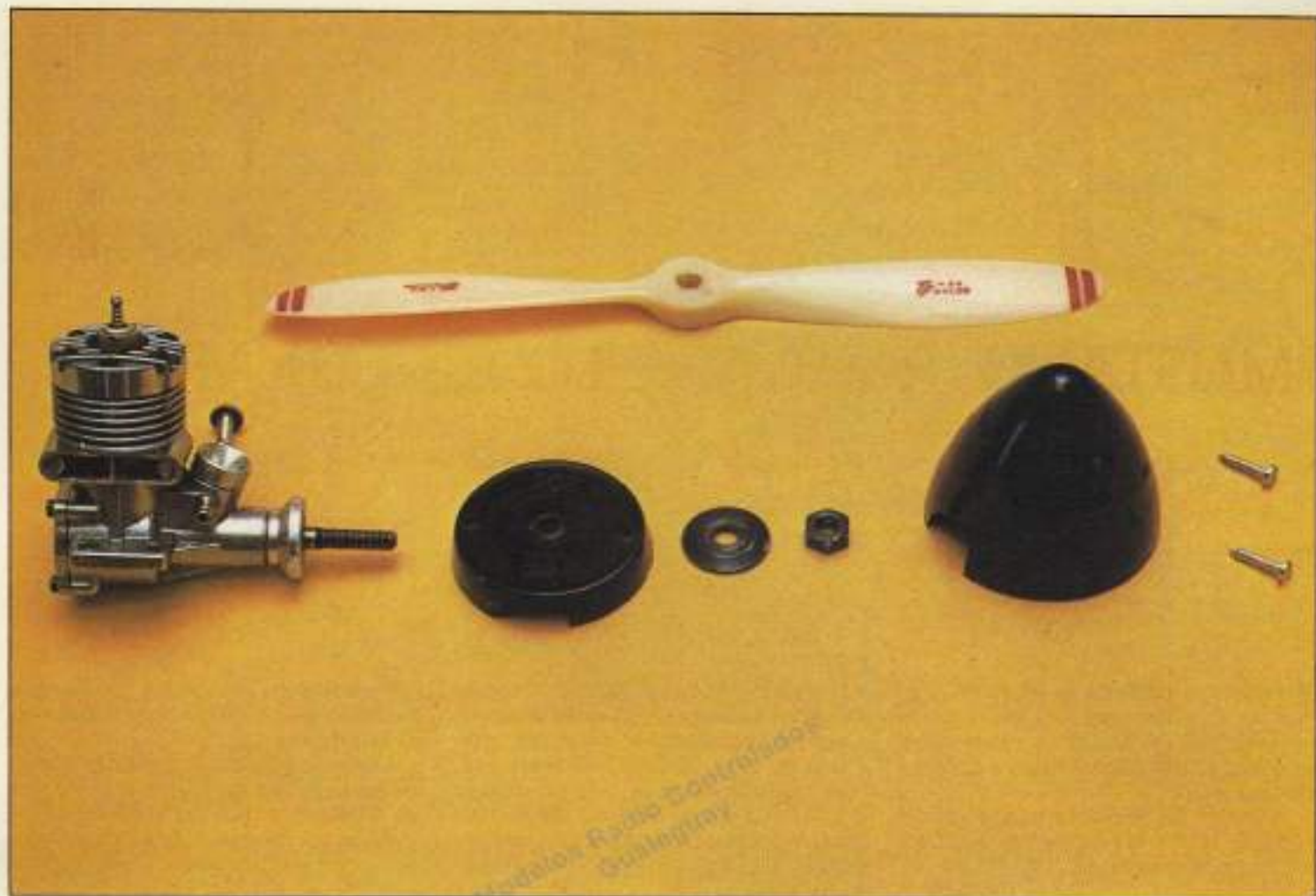
El motor apropiado para ser instalado en el «Mustang», junto con la hélice de nylon correspondiente y el cono de plástico.
