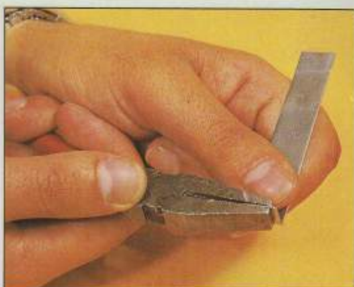
8. Con una pletina de chapa se hará una brida que servirá para sujetar el depósito de combustible al fuselaje.
