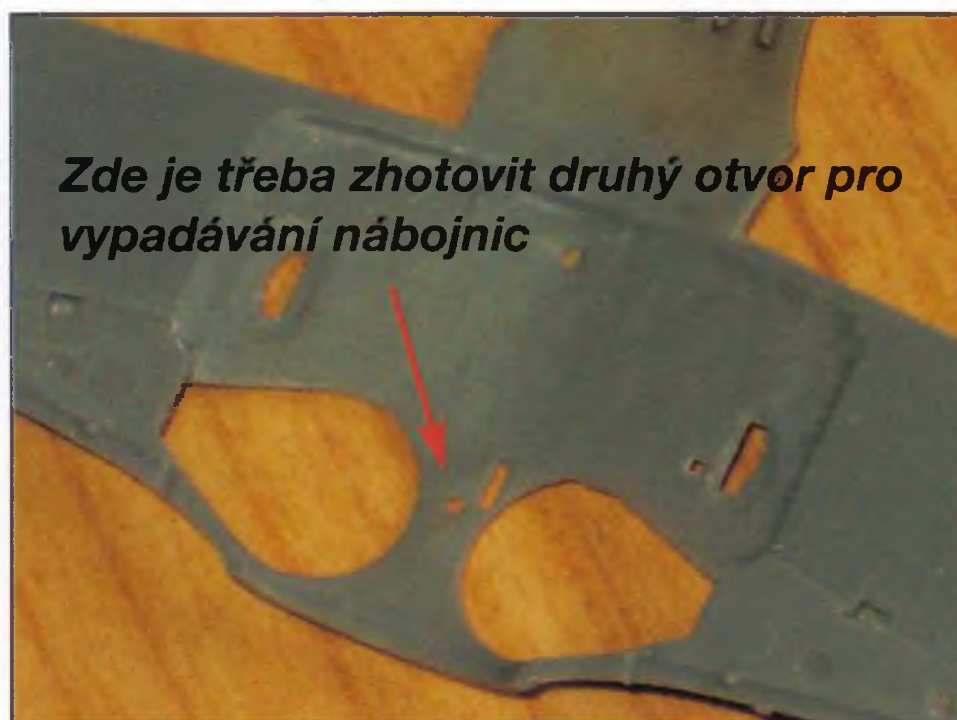
Zde je třeba zhotovit druhý otvor pro vypadávání nábojnic
