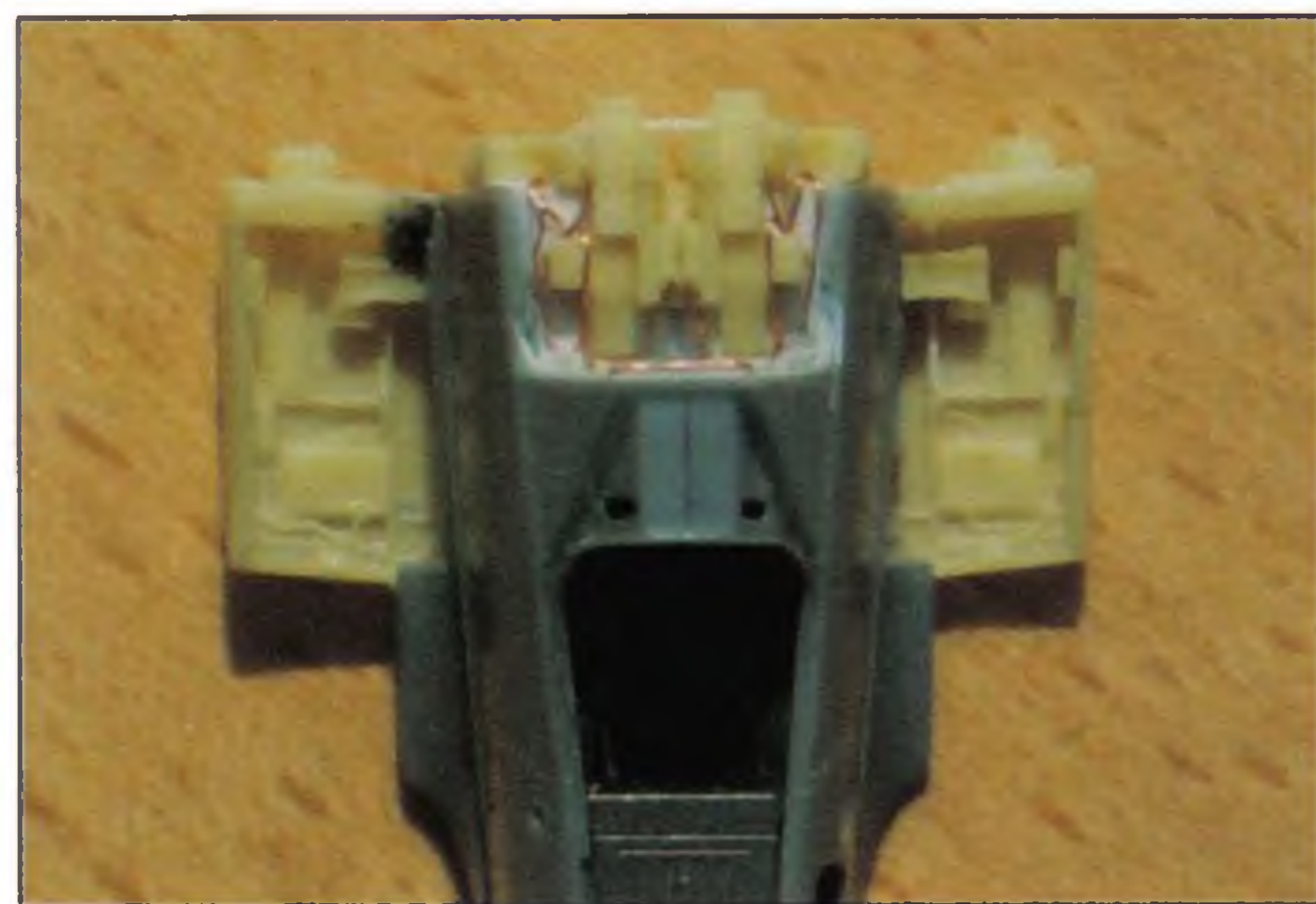
Přepážka za motorem se zásobníky munice
