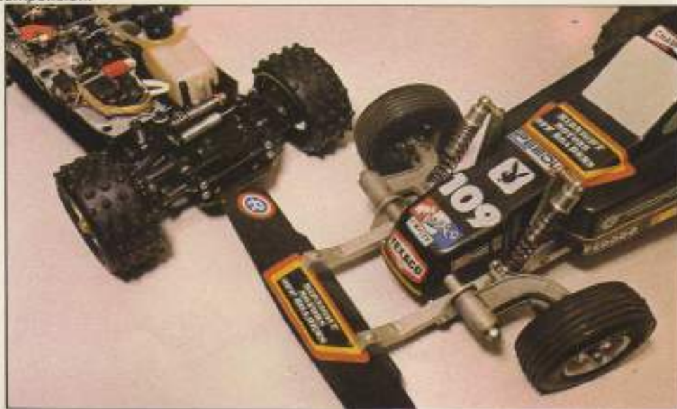
Detalle de los dos tipos de suspensión: brazos oscilantes y trapecios.
