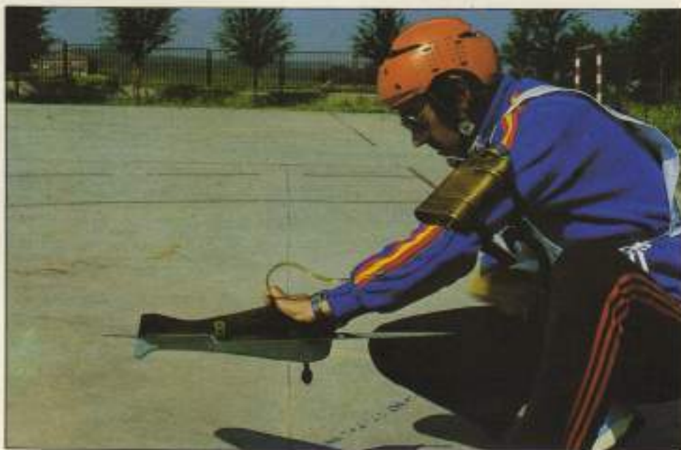
El mecánico está repostando. Obsérvese el depósito de carga situado en el brazo y la utilización de guantes.
