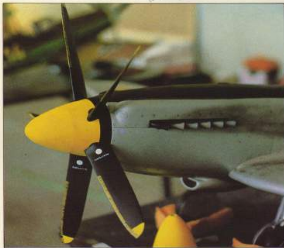
Algunas hélices multipalas son sólo una reproducción a escala, de bajo rendimiento.
