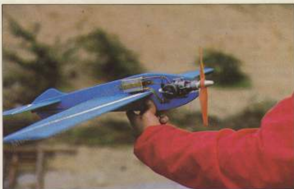
En un modelo de carreras libres, el depósito y el motor están al aire.
