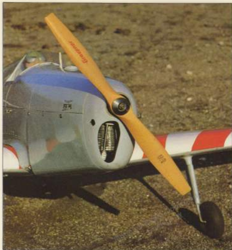
La hélice deberá estar suficientemente apretada para evitar sorpresas desagradables.
