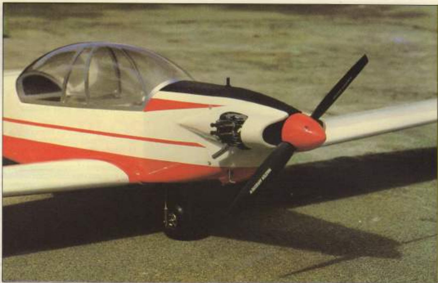
El perfecto equilibrio de la hélice es fundamental para el buen funcionamiento del motor, al eliminar las vibraciones.
