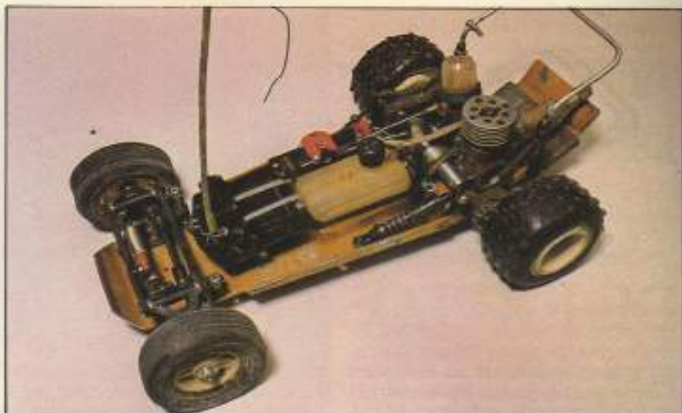
Modelo de tracción convencional con mecánica simple y robusta. No hay problema de espacio.
