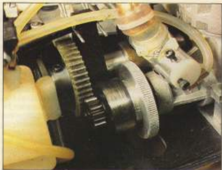
El primer punto de la transmisión es el embrague centrífugo.
