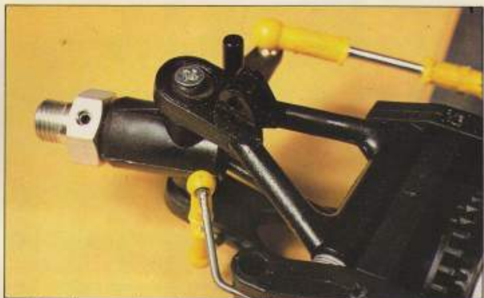
El sistema de suspensión por trapecios es sin duda el más robusto y preciso.
