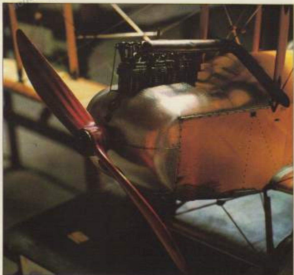
La hélice de la fotografía tiene paso «a izquierda». Generalmente suelen ser «a derechas».
