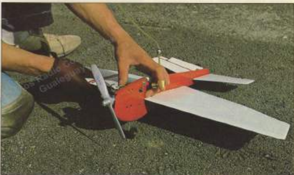
Este modelo de carreras libres lleva depósito con válvula de llenado.
