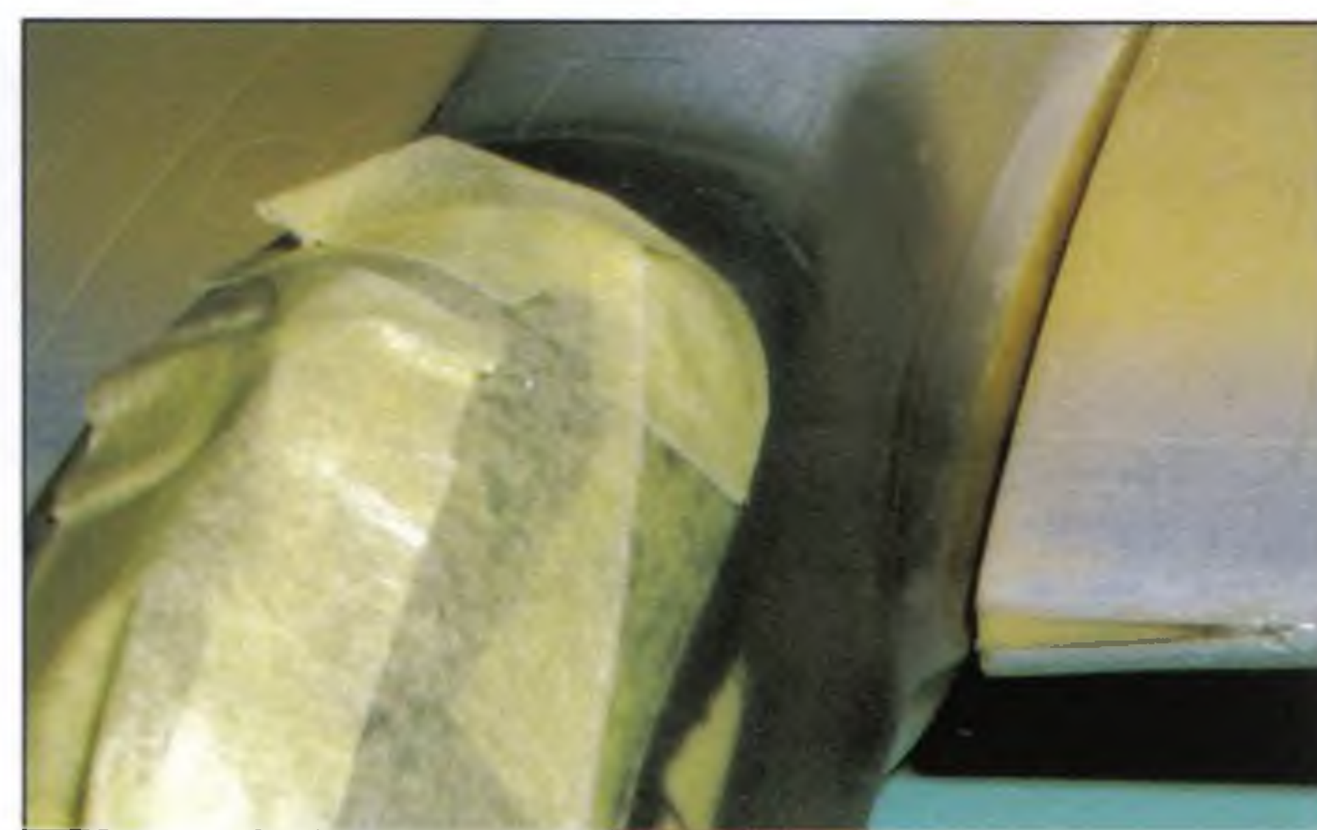
Poučen z předchozích nezdarů jsem je začal lepit od koncového oblouku a napojení k trupu ve správné výšce jsem řešil až nakonec. V náběžné hraně se vytvořila opět nehezská škvíra, která dala prostor k vyplnění dalším mililitrům „prstolepu“. Napojení křídla k trupu byl problém – škvíra po celé délce nahoře a schod v přední části vespod
