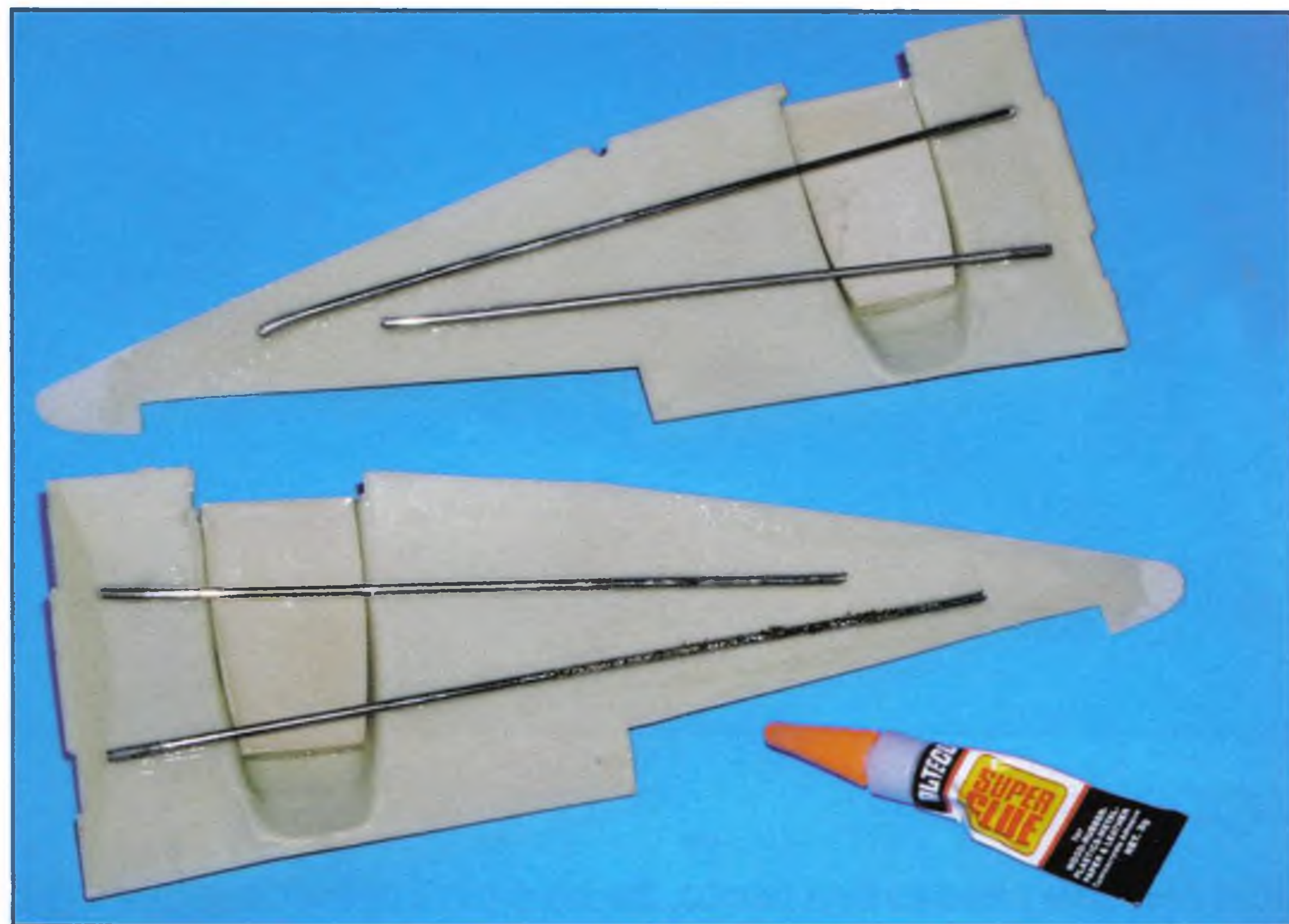
Díly křídla byly v obou stavebnicích zkroucené, musí je nejprve vyztužit. Použil jsem drát z výpletu jízdního kola, vlepený vteřinovým lepidlem do obou polovin křídla
