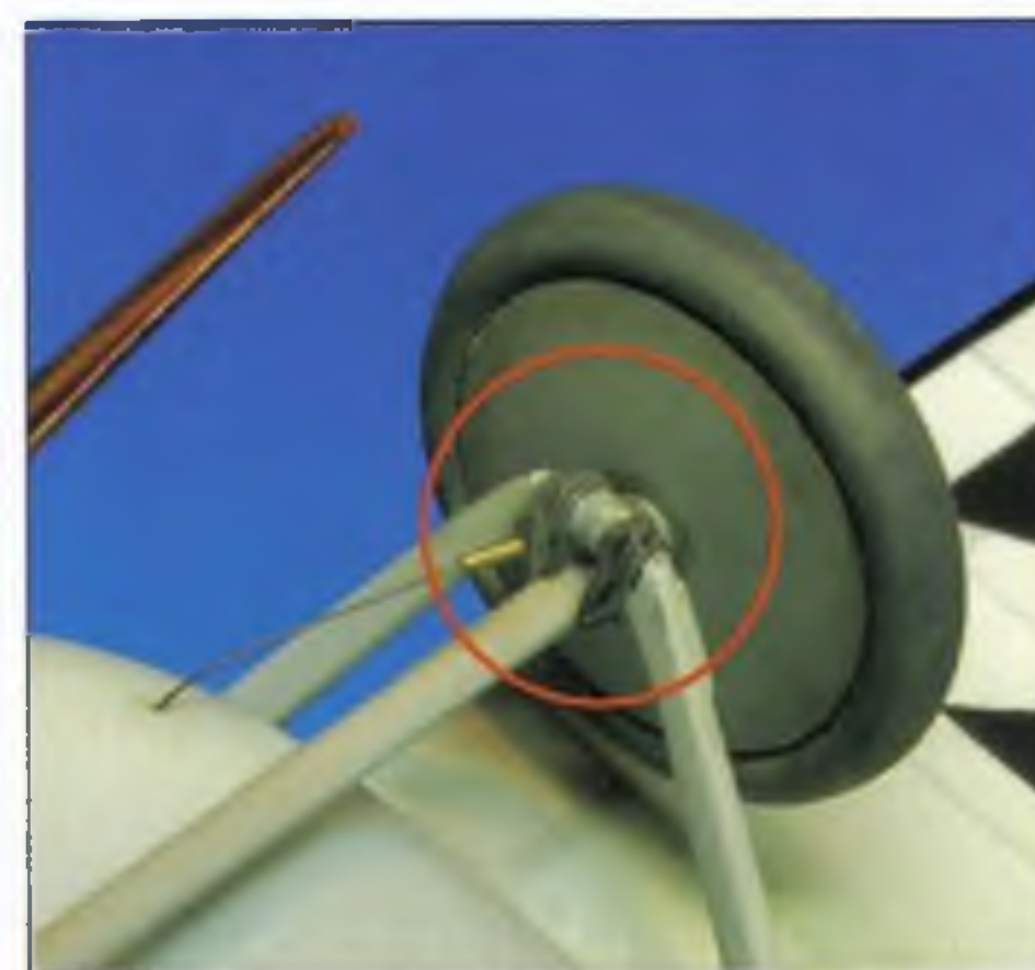
Gumové odpružení z olověného drátu o průměru 0,2 mm
