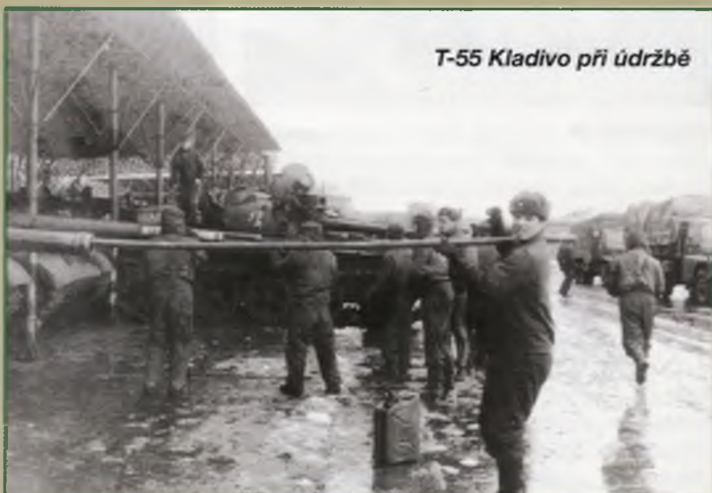
T-55 Kladivo s odmontovaným přídavným pancéřováním, všimněte si množství přivázané bagáže
