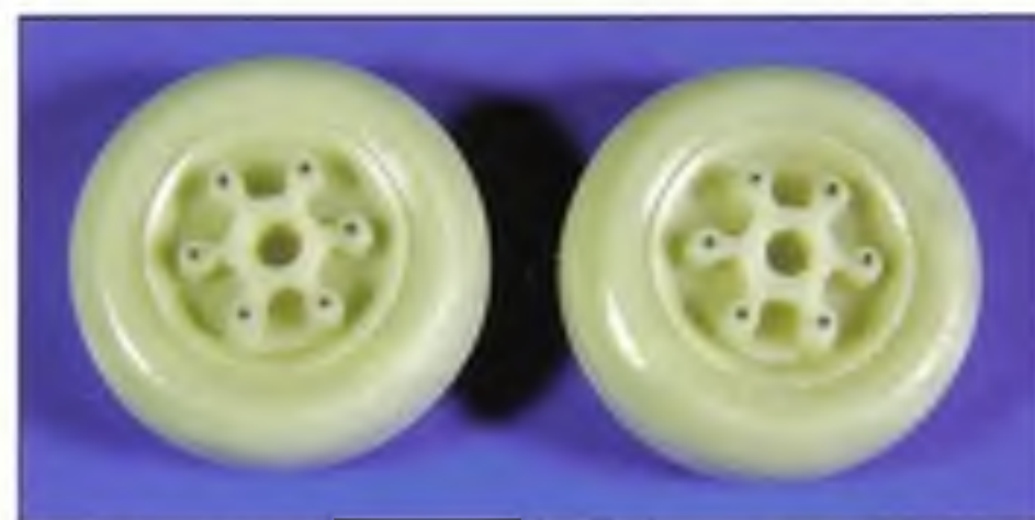
Malé matice na kolech byly polámané a zalité. Zhotovil jsem nově z plastové tyčinky
