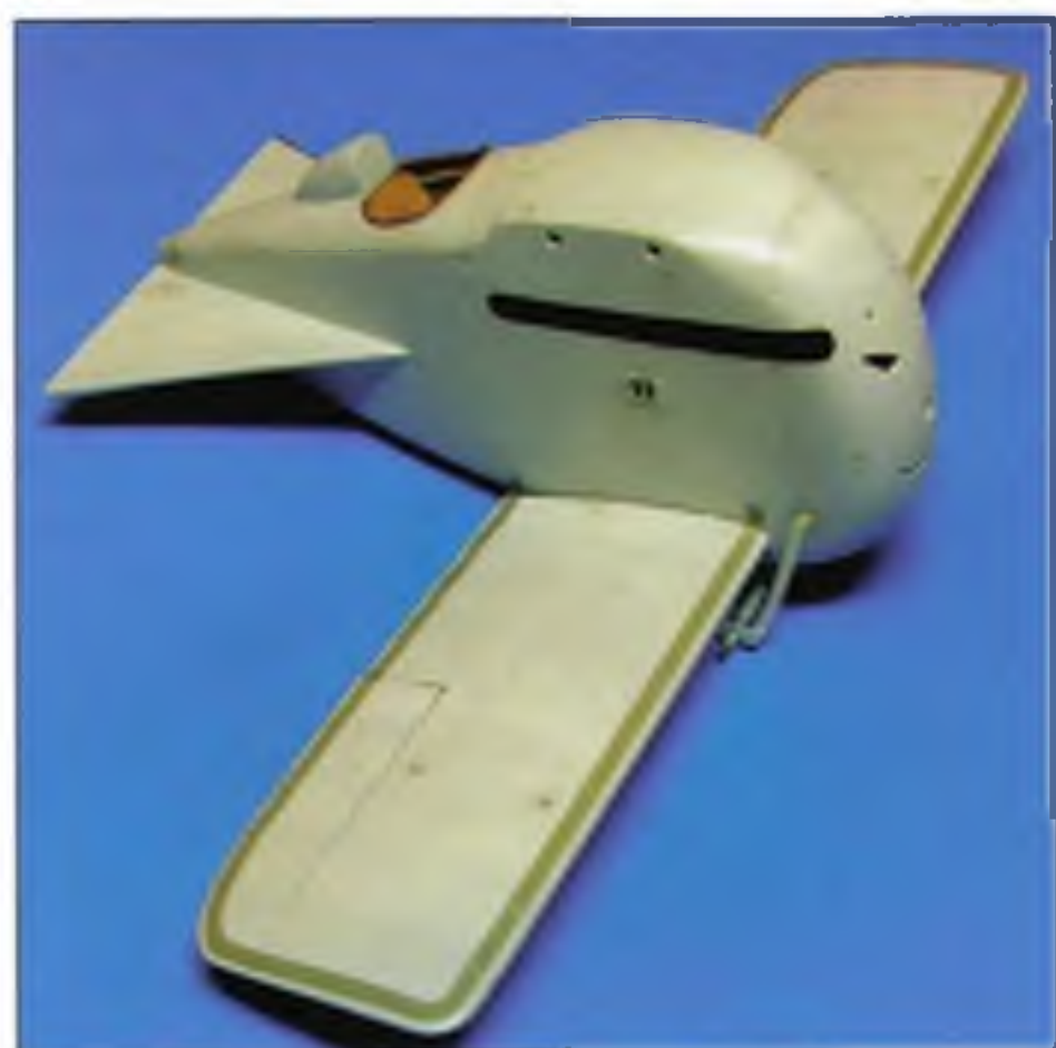
Zajímavým prvkem je lemování křídel, výškovky a směrovky černou barvou. Pro zjednodušení práce jsem si zhotovil šablony z maskovací fólie
