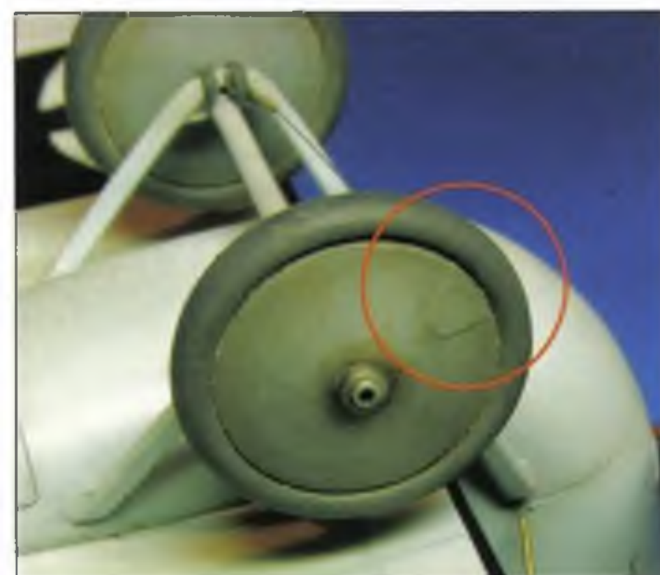
Na kolech jsem zatmelil otvory pro ventilkky a zhotovil krytky
