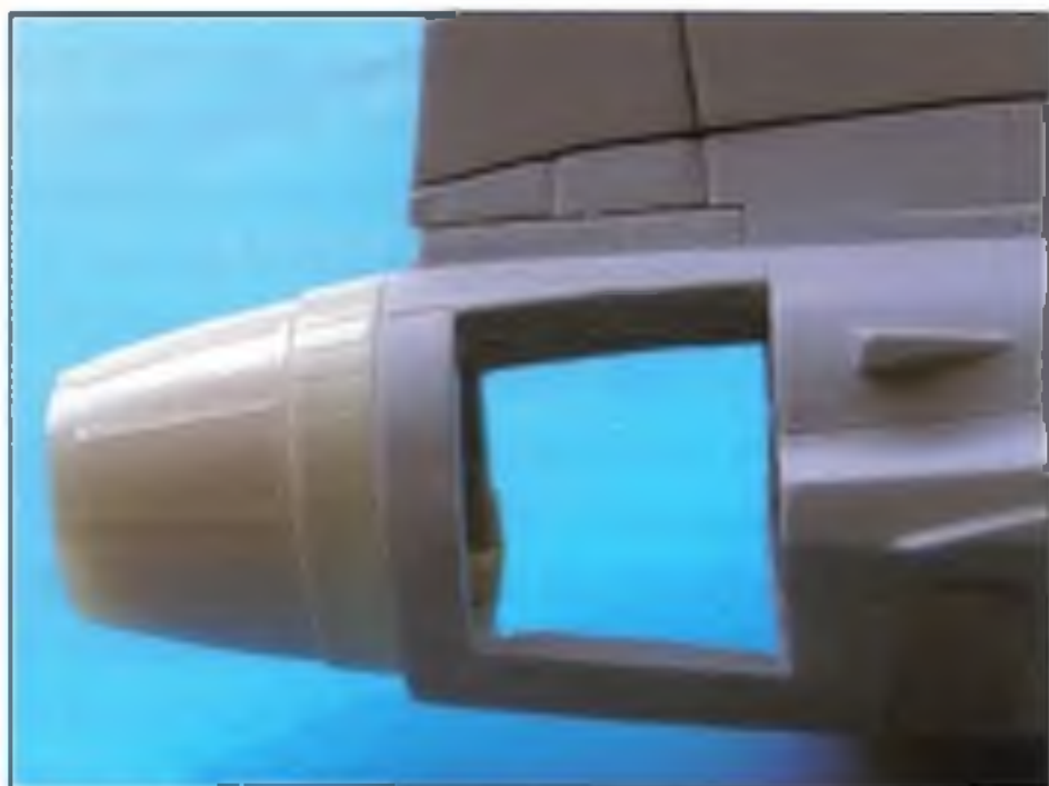
Odlévaná tryska má asi o 1,5 mm menší průměr než je průměr trupu
