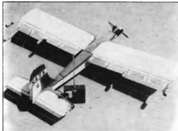
Μοντέλο τού προγράμματος γιά τήν έρευνα τών στροβίλων μέ τεμαχισμένα φλάπς.
