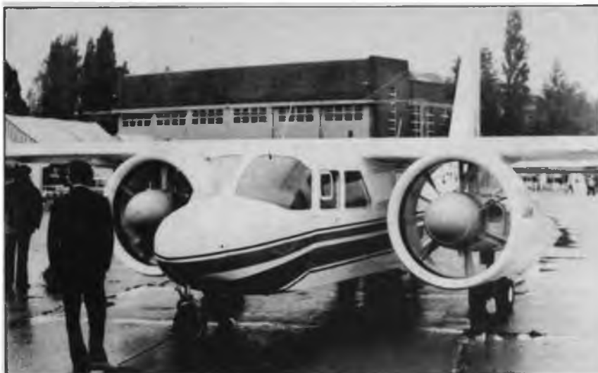
Τό γνωστό μας Islander με τό νέο σύστημα έλικων (Ducted Fan) τής εταιρείας Dowty.
