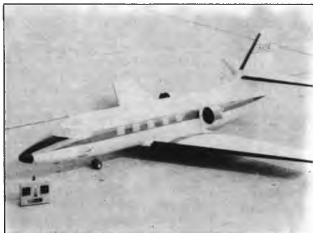
Μοντέλο τού προγράμματος γιά τήν έρευνα τών στροβίλων μέ τεμαχισμένα φλάπς.
