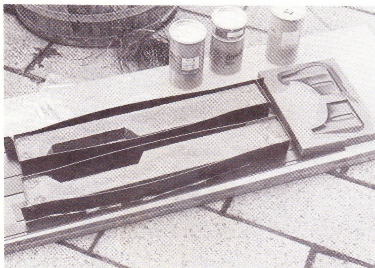
Støbesand er påfyldt for kropformen. Haleformen er færdig.
