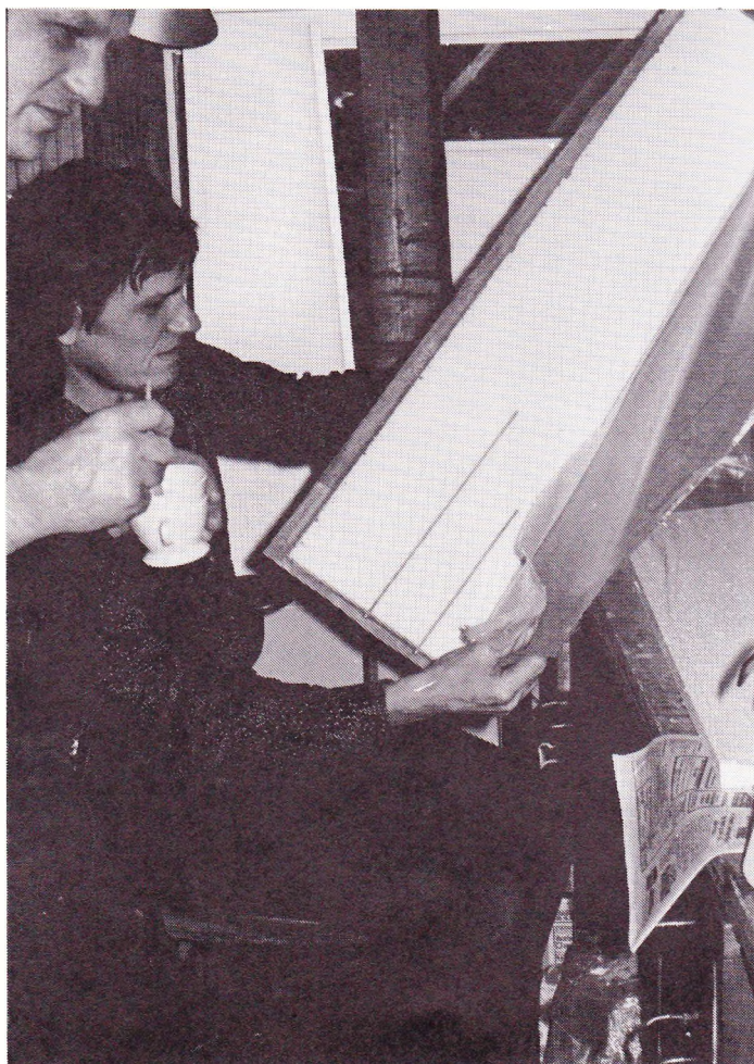
Øverst t.v.: Den færdige skumkærne med indlimede rør til Lutz-mekanisme.
