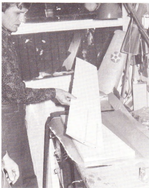
Den færdige skumkerne med indlimede rør til vingevrid-mekanismen. På bordet ses negativformen.
