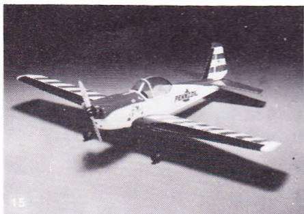
EZ Super Chipmunk. Næsten færdig model. Beregnet for 4 cm 3 totakt, eller 6 cm 3 firtakt motorer. Spændvidde 130 cm.
