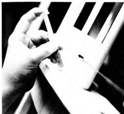
Remove shims and pour in Hobbypoxy No. 2.
